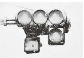
発光部に雪が付着し、全く見えなくなったLED式の信号機＝2日午前8時55分、盛岡市永井
